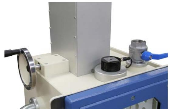
Mit der Kurbel wird der Korb inklusive Halter in das Infiltrierbad gesenkt. Die Außen liegende LED – Leuchte sorgt für genügend Kammerlicht ohne Platz vom Innenraum zu nehmen.
