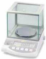
**Glas-Windschutz** mit 3 Schiebetüren links, rechts und oben, Wägeraum BxTxH 150x140x130 mm, nachrüstbar bei Modellen mit Wägeplattengröße [A], **KERN EG-A03, € 140,-**
