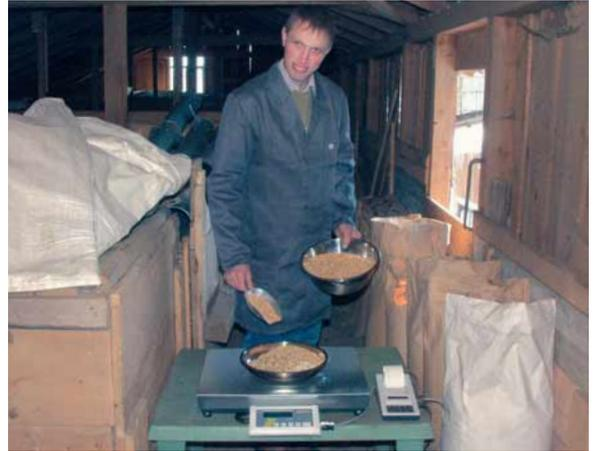
**Mit der Rezeptur-Funktion** lassen sich verschiedene Bestandteile einer Mischung zuwiegen. Zur Kontrolle kann das Gesamtgewicht aller Bestandteile aufgerufen werden
