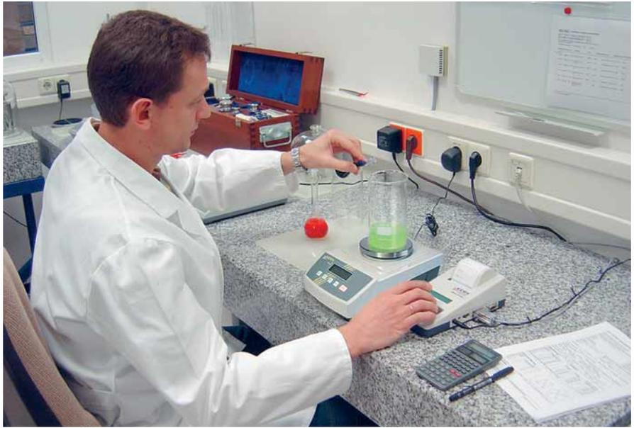
Mit der Rezepturfunktion lassen sich verschiedene Bestandteile einer Mischung zuwiegen. Zur Kontrolle kann das Gesamtgewicht aller Bestandteile aufgerufen werden. Dokumentation der Mischung mit Standard-Drucker **KERN YKB-01N** 2 möglich.
